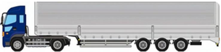
軸種 | 軸数: 5軸、トラクタ前1軸、トレーラ後3軸
